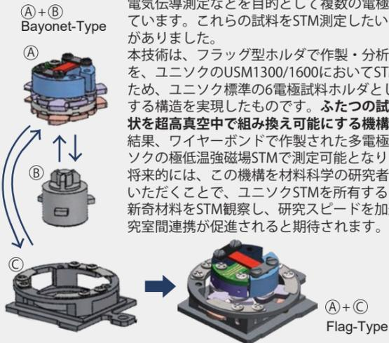
材料科学研究で 사용되는試料作製・分析装置では、フラッグ型試料ホルダが主流となっており、一般的に電気伝導測定などを目的として複数の電極が備えられています。これらの試料をSTM測定したいという要望がありました。本技術は、フラッグ型ホルダで作製・分析された試料を、ユニソクのUSM1300/1600においてSTM測定するため、ユニソク標準の6電極試料ホルダとしても機能する構造を実現したものです。ふたつの試料ホルダ形状を超高真空中で組み換え可能にする機構を導入した結果、ワイヤーボンドで作製された多電極試料もユニソクの極低温強磁場STMで測定可能となりました。将来的には、この機構を材料科学の研究者に採用していただくことで、ユニソクSTMを所有するグループが新奇材料をSTM観察し、研究スピードを加速させる研究室間連携が促進されると期待されます。
