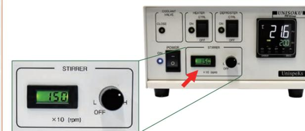
A rotation indicator of magnetic stirrer is available. 温度コントローラーにスターラーの回転数表示機能を追加
